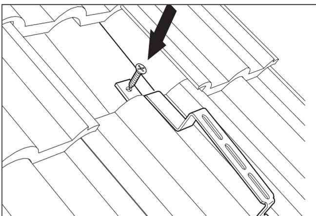
Рис. 4.5 В отличие от рис 4.4 анкера могут быть непосредственно закреплены приложенными шурупами к стропилам (без вставки).
